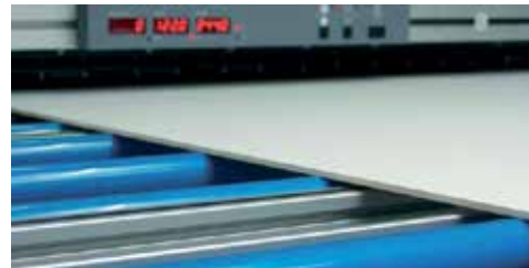
Zuschnitt bei Raumtemperatur (ca. +15 bis +25 °C) klimatisieren und mit Staubbindetuch, Antistatiktuch oder speziellem „Cleaner“ (z.B. PCR-Roller) von Staub- und Schmutzpartikeln befreien und vorsichtig auf der Druckzuführung ablegen.
