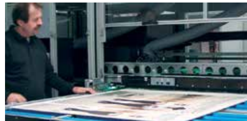
Plattenhandling nach dem Druck Platten zum Ablüften möglichst flächig auslegen. Vermeiden Sie bei Kantenaufgabe den direkten Bodenkontakt.
