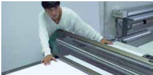
Plattenhandling vor dem Druck Platte auf das gewünschte Maß zuschneiden
