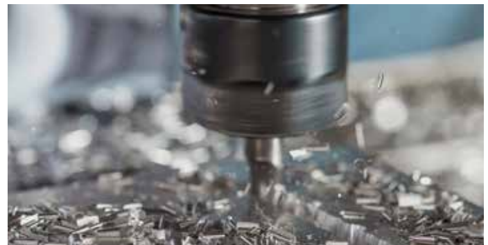
CNC-Bearbeitungen: Lochbohrungen, Fräsungen etc.
